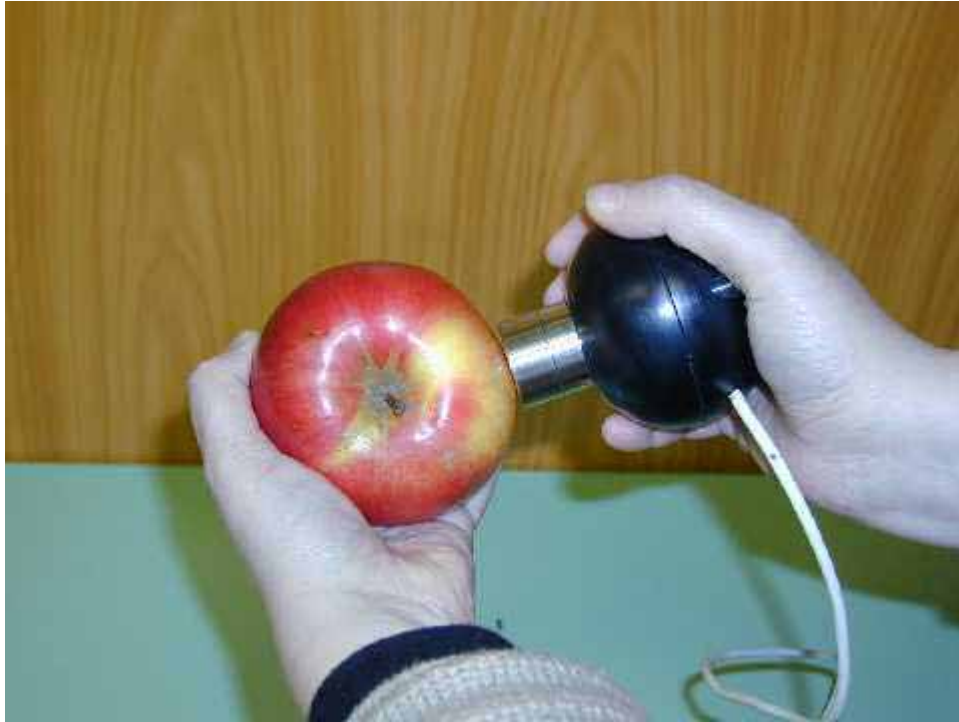
3. ábra. Keménységmérés a műszerrel
